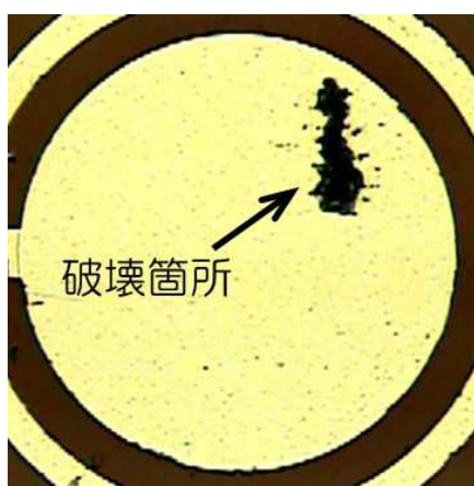
図 1. 322MeV-Kr イオン入射により破壊した SiC MOS キャパシタの顕微鏡写真
